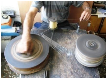
شکل ۱۰- انتقال مفتول‌های حدیده شده از قرقره منجر به قرقره جر (عکس از نگارنده)
