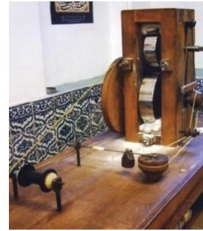
شکل ۱۱- دستگاه نَقدَه کوبی یا نَورد (ادیب، ۱۳۸۹، ۵۸)
