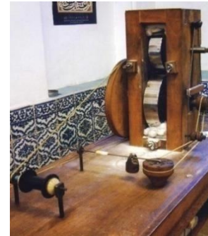
شکل ۱۱- دستگاه نَقدِه کوبی یا نَورد (ادیب، ۱۳۸۹، ۵۸)
