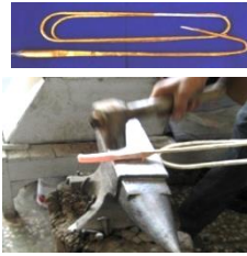
شکل ۷- چکش کاری مفتول نقره طلا پیچ شده (عکس از نگارنده)
