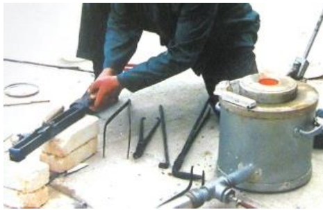
شکل ۱- ذوب نقره و ریختن آن در قالب ریچه (ادیب، ۱۳۸۹: ۴۲)
