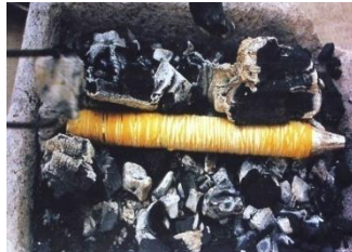
شکل ۶- حرارت دادن به مفتول برای تثبیت ورق طلا (ادیب، ۱۳۸۹، ۴۷)
