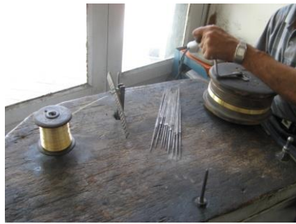
شکل ۹- دستگاه نازک کشی (عکس از نگارنده)
